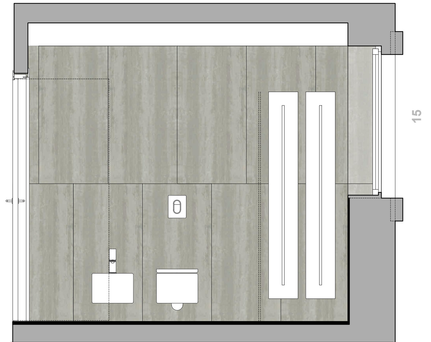
prospetto lato sanitari - scala 1.20
